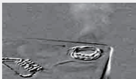
容器内からの VOC 蒸気
