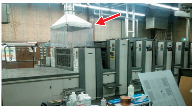
図：局所排気装置の実施例
