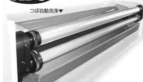
●インキつぼを覆うカバーフィルムを用いた、インキつぼ・つぼローラー自動洗浄システム。
