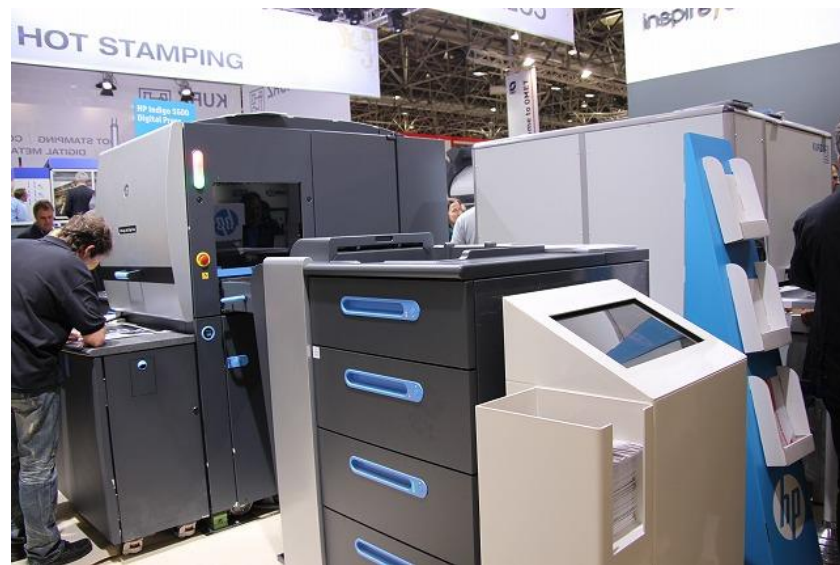
Kruzのdigital metalでシリアル番号作成(左) デジタルプレスで転写イメージを作成、そこにdigital metalを転写(右)
