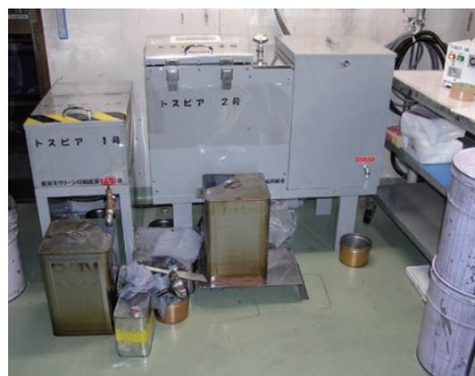
写真 13 溶剤回収・再生装置
