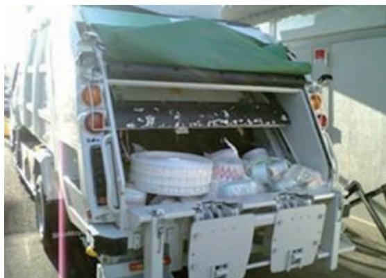
写真 14 RPF化用廃プラスチックの回収
