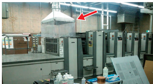
図：局所排気装置の実施例
