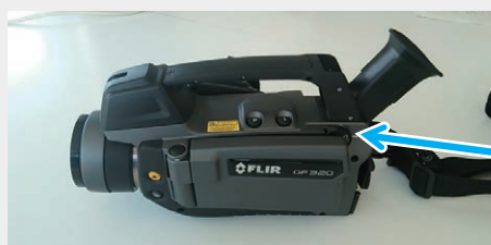
VOC 可視化に用いた 赤外線サーモグラフィ
