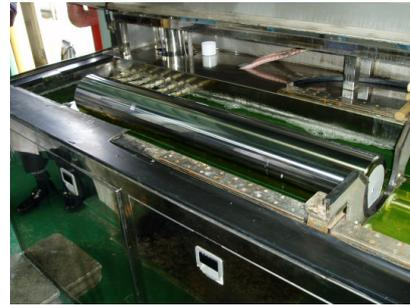
シリンダー装着後の様子。装着にはクレーンを用いる。
