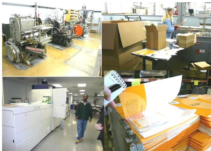
図 3-15 凸版印刷機は箔押しや抜きなどの加工用（左上）、Xerox iGen3（左下）が見える
