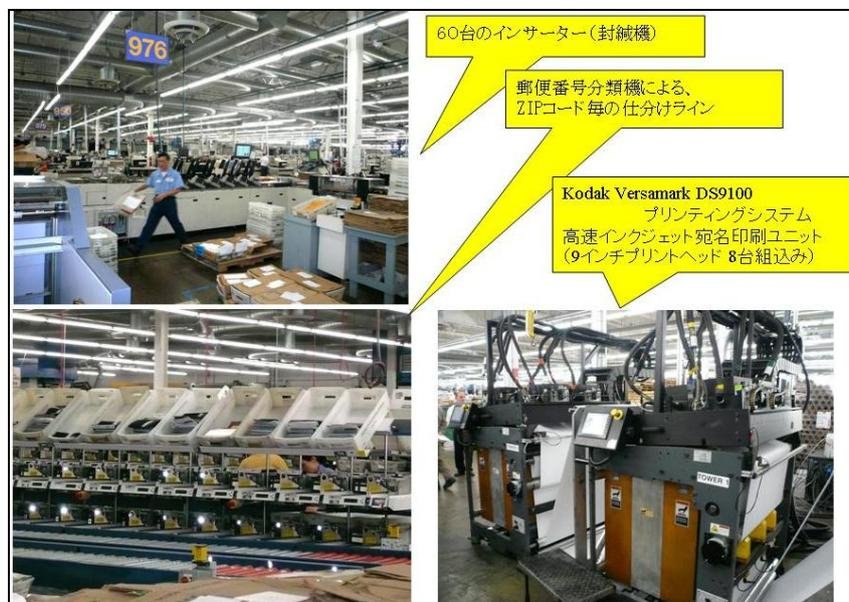
図 3-8 Kodak Versamark DS9100 プリンティングシステム による宛名の高速バリアブル印刷（右）
