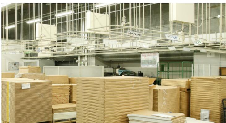
図 3-44 RFID タグによる白紙の在庫管理（天井から下がっているのが読取装置）
