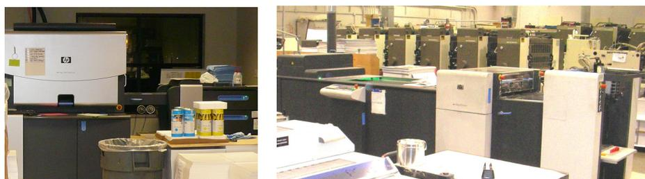
図 3-32 オフセット+HP Indigo7000などでハイブリッド印刷（左）/IndigoUV コーターで表紙加工（右）
