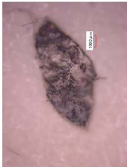
写真4. 低濃度溶解後のPP片 (①PP/PE)
