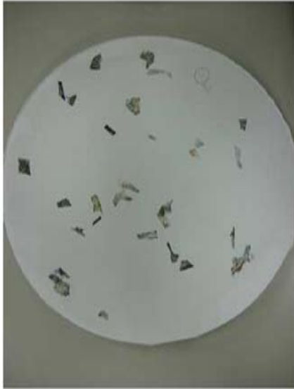
写真2. 低濃度溶解後のシート (①PP/PE)
