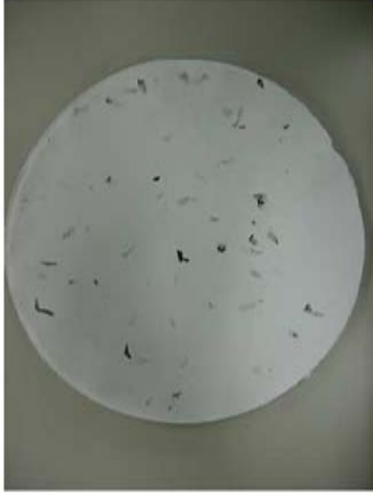
写真3. 低濃度溶解後のシート (⑤PET+アクリル)
