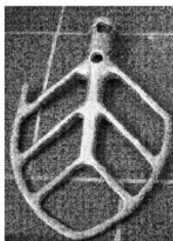
図 1 : Hobart パルパーの攪拌器
