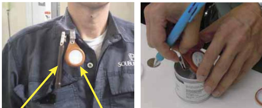
図 16 左) アクティブサンプリング、パッシブサンプリング（ガスモニター）を装着
