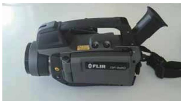
図 12 VOC 可視化に用いた赤外線サーモグラフィ：FLIR 社 GF320
