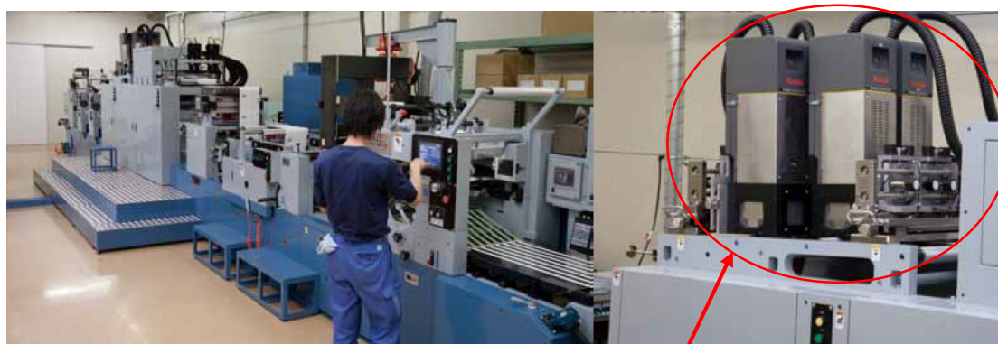
図 15-17 : 2 色ビジネスフォーム印刷機に Prosper S5 を 4 台搭載した印刷システム (4 台搭載により最大印字幅 422m を実現)
